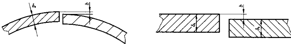
图 17 圆筒与筒体的对口错边量
